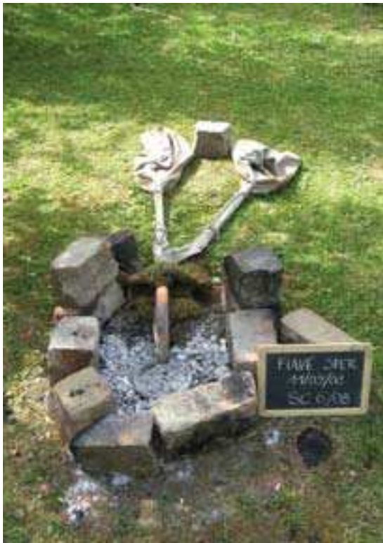
Fig. 2. Esempio di esperimento in crogiolo in buca, con l'ausilio di un mantice a doppia sacca.
