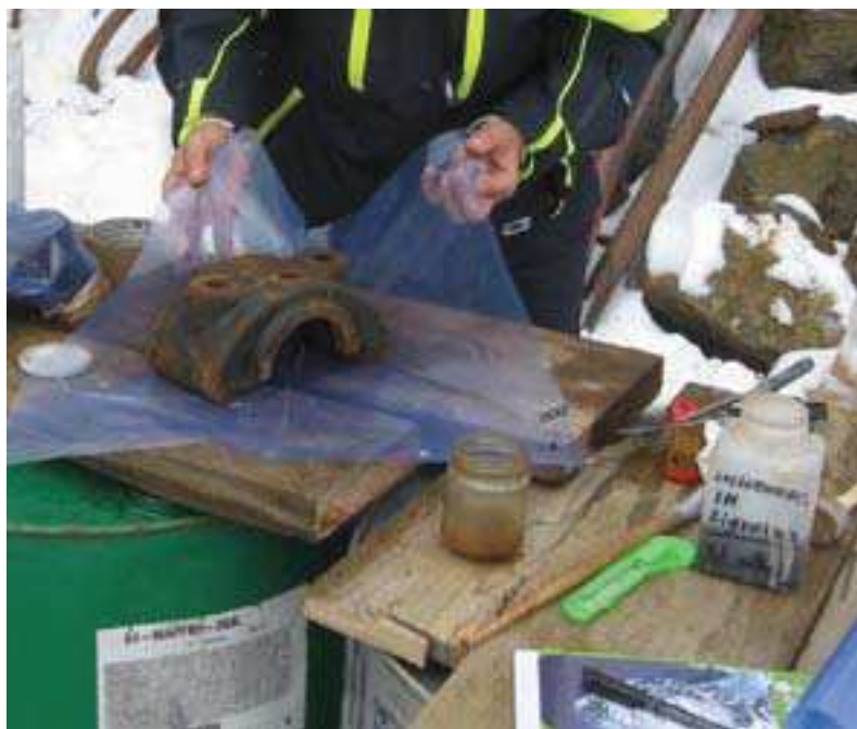
Fig. 5. Imballaggio dei reperti metallici in situ con buste di polietilene caricate con VCI.
