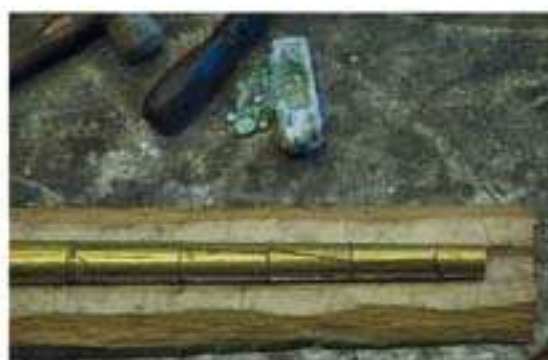
1. realizzazione delle sagome in legno per la modellazione tramite battitura delle lamine
