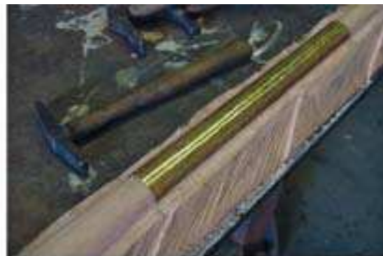
1. realizzazione delle sagome in legno per la modellazione tramite battitura delle lamine
