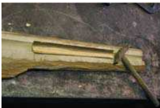
1. realizzazione delle sagome in legno per la modellazione tramite battitura delle lamine
